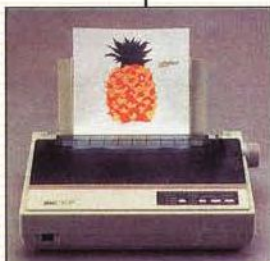
LC-100 Colour Stampante a colori a 9 aghi, 80 colonne, velocità 180cps
